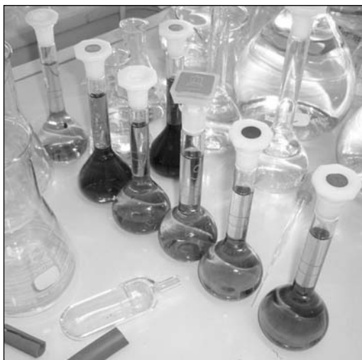
4. ábra Egy nyilvánvalóan hibás oldatsorozat spektrofotometriához
