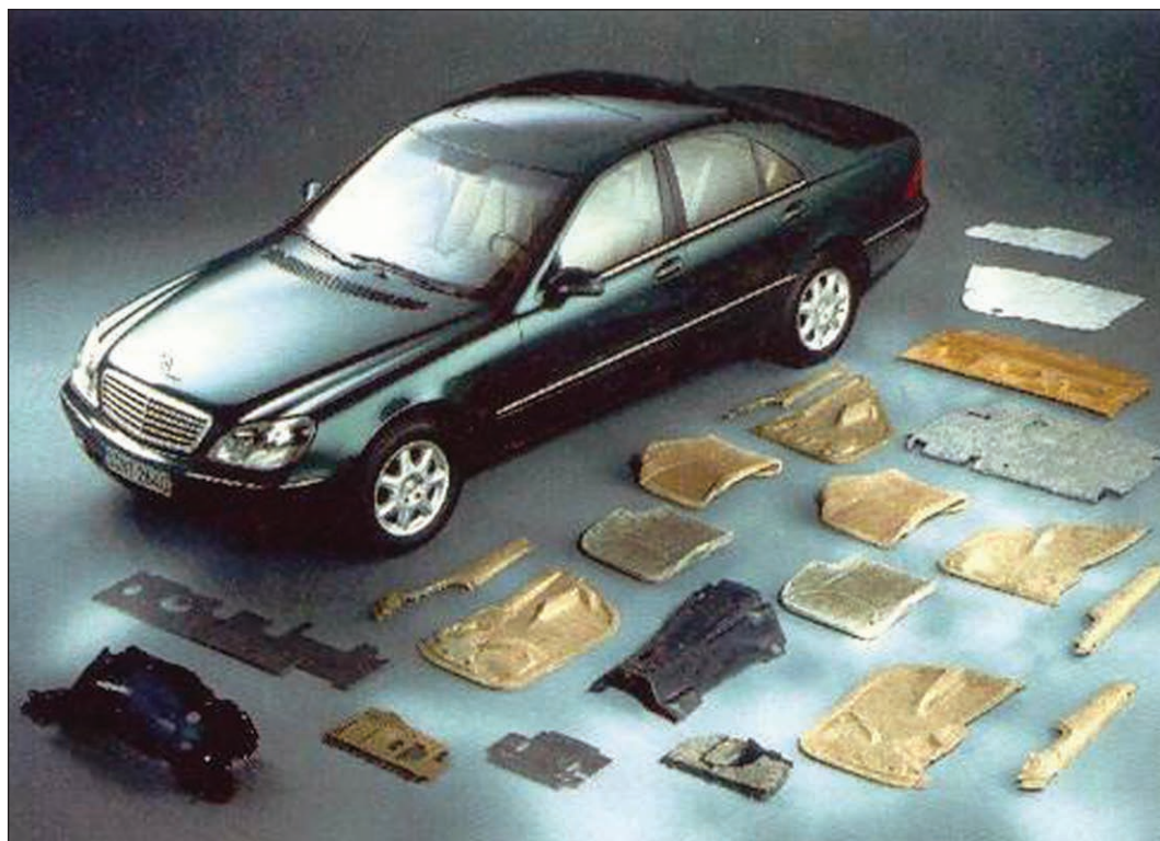
12. kép Kompozit alkatrészek egy mai gépkocsiban
