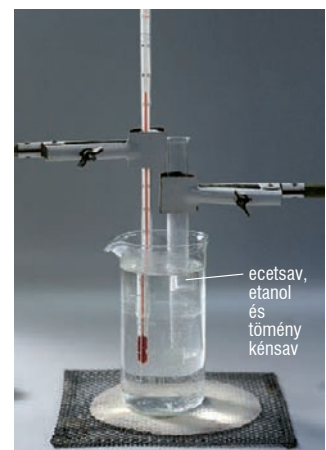
271.1. Az etil-acetát előállítása
