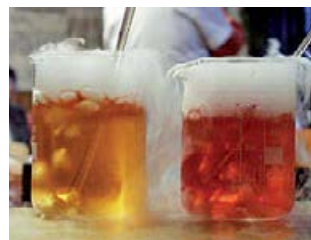
266. ábra „Forrongó színek”. Szárazjég szublimálásával keletkező szén-dioxid-gáz apró folyadék-cseppeket ragad magával a színezett vizes oldatokból
